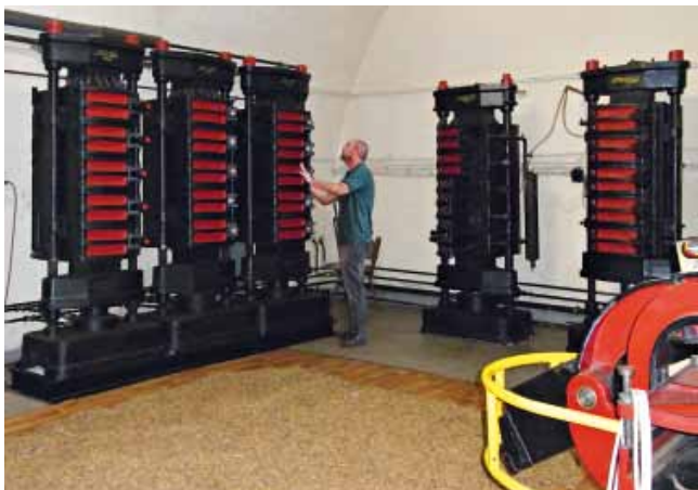
Unsere beheizbaren hydraulischen Flake-Pressen
